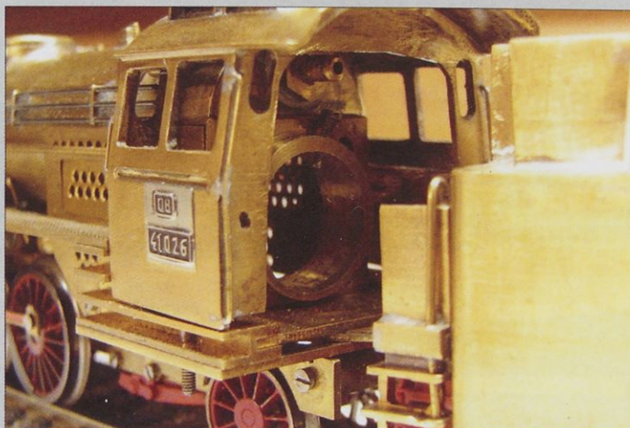
Okrogla odprtina v kabini lokomotive je namenjena za plinski gorilnik.
