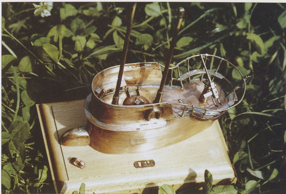
Za prikaz načina izdelave makete podmornice U-99 je Franci Urh posebej izdelal komandni stolp podmornice iz bakrene pločevine. Na tej mini maketi se lepo vidi, kako so izdelani posamezni deli, ki jih je nato s spajkanjem združil v celoto.
