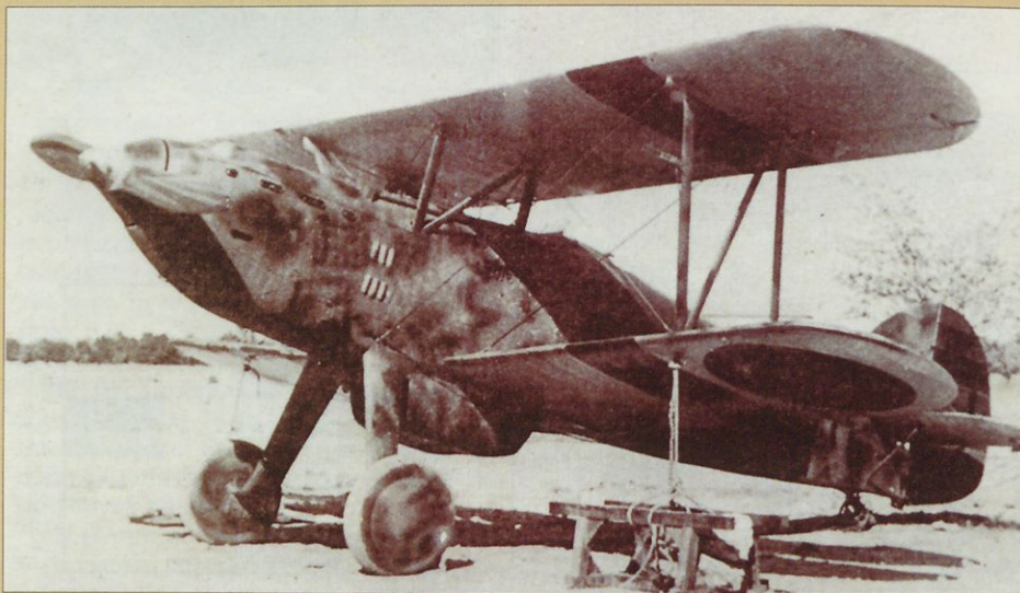
Na edini znani fotografiji tega letala je opazna drugačna oblika hladilnika.
