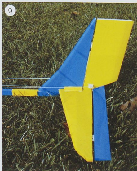
Trup iz stiroporne sredice, oblepljen z lepilnim trakom, pa je kot nalašč za takšne vrste pristankov.
