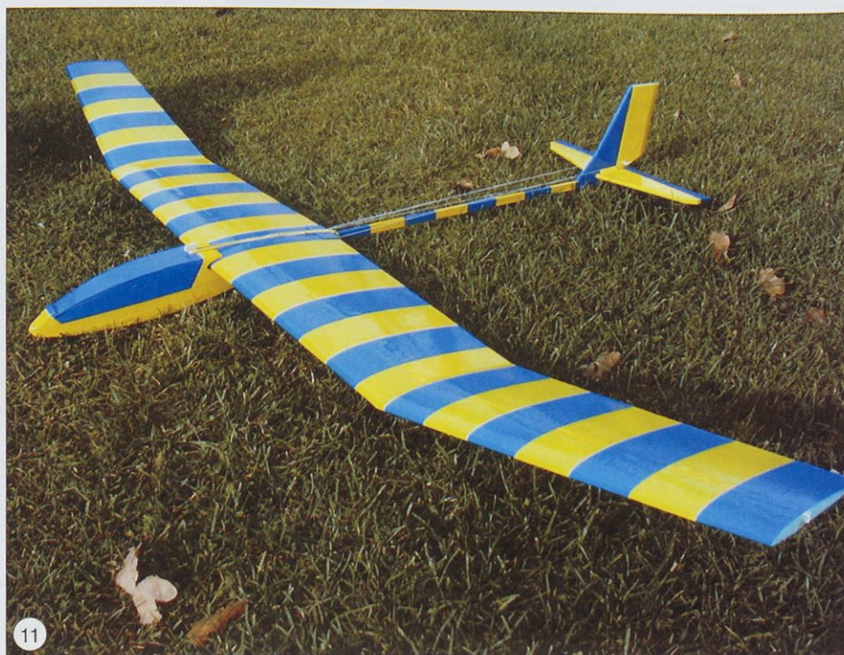
Trup iz stiroporne sredice, oblepljen z lepilnim trakom, pa je kot nalašč za takšne vrste pristankov.
