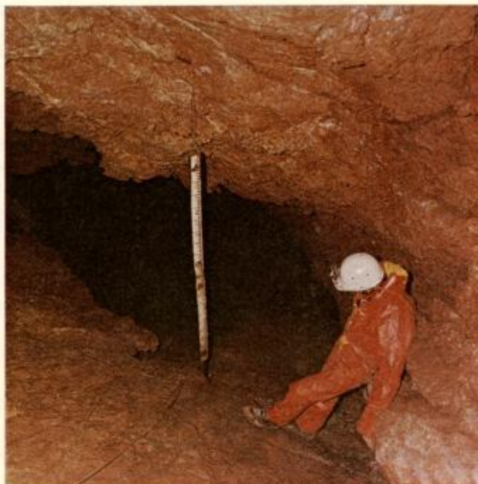
Fig. 5. Aven Drča jama. On aperçoit, derrière l'échelle limnimétrique, le plan d'eau rabattu par le pompage d'essai dans le forage B-5
