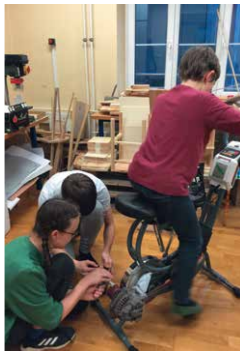
Slika 3: Sobno kolo, prirejeno za polnjenje mobilnih naprav
