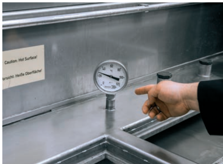
» Temperatura čistilne kopeli ne preseže 30 °C.
