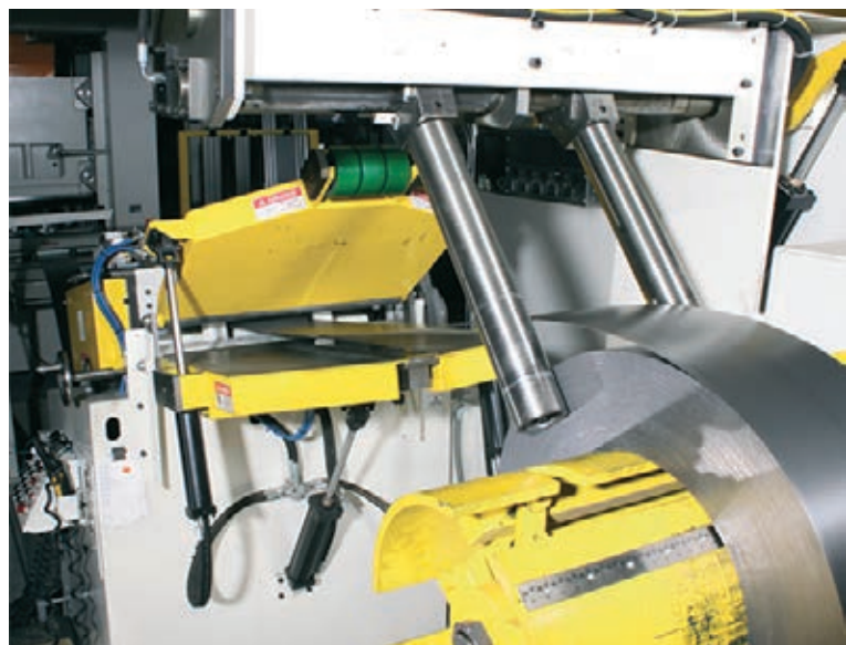
»Gnana vodila koluta se pozicionirajo s pritiskom na gumb, zato je delavcem prihranjeno naporno in nevarno delo z ročnimi vodili.
