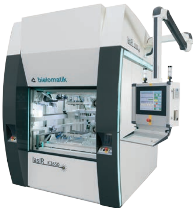
» Visokotehnološka proizvodna enota, popolnoma avtomatizirana z roboti, za varjenje posod za sečnino pri čiščenju izpušnih plinov na SCR-procesu
