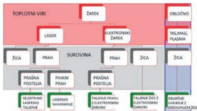
» Slika 2: Razdelitev postopkov aditivnih tehnologij za izdelavo kovinskih izdelkov [5]
