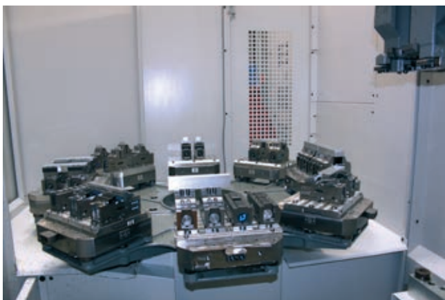
» Paletni magazin za osem palet 320 x 320 mm in desno zgoraj portalni prijemalni sistem za transport palet, skupno sistem vsebuje 11 palet s različnimi ali enakimi vpenjalnimi priključki, po želji uporabnika.
