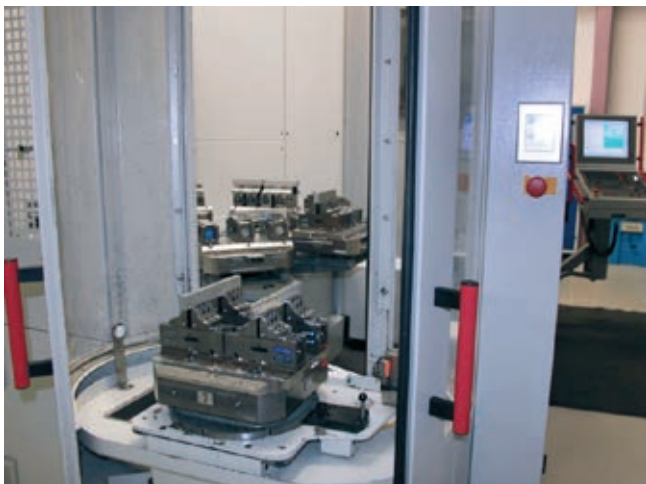
» Nastavitvena postaja za 320 x 320 mm paleto za simultano nastavitve palete in obdelovanca.
