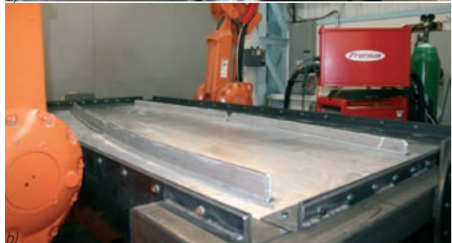
» Slika 4: a) Nosilec letalskega kolesa iz titana in b) rebro letalskega krila iz aluminijeve zlitine [5]
