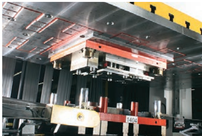
» Orodja pri Millerjevi novi stiskalnici drži najsodobnejša magnetna vpenjalna tehnika.
