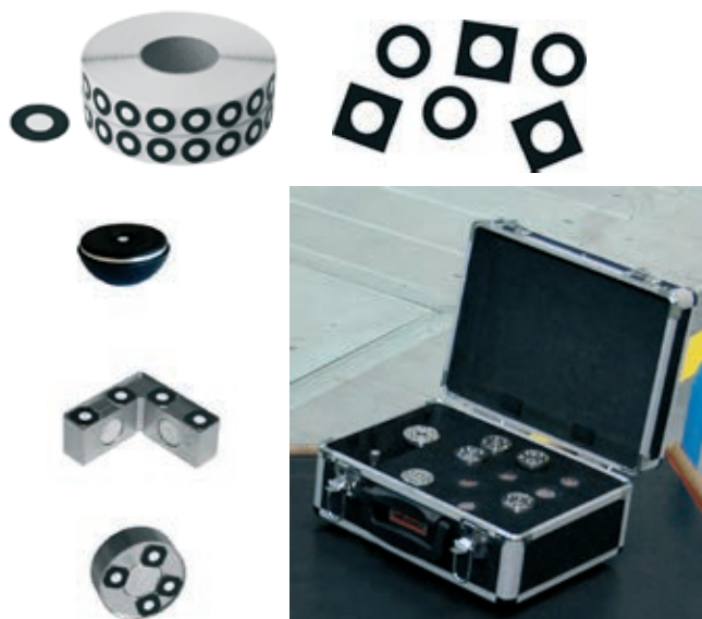
» Slika 3: Potrošni material TRITOP CMM : samoadhezivni in magnetni markerji, kontrolni adapter, specialni adapter za merjenje okvira
