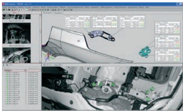
» Slika 5: 3D-koordinate merjene na temelju serije 2D-slik v programu TRITOP
