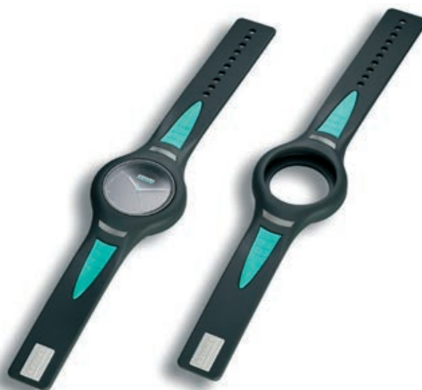
» Električni dvokomponentni Allrounder 570 A je v 75-sekundnem taktu brizganja popolnoma samodejno izdeloval dve dvobarvni zapestnici iz tekočega silikona.
