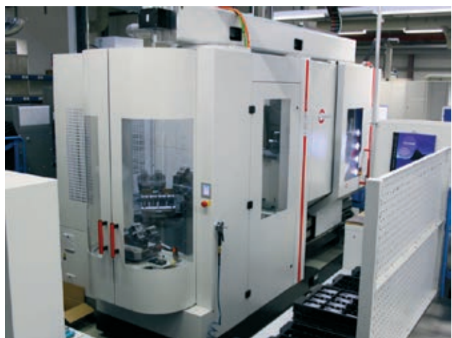
» Petosni visoko zmogljiv CNC-obdelovalni center C 22 UP Hermle (na sredini), paletni sistem s paletnim magazinom (spredaj) in dodatnim magazinom orodij ZM 87 s 87 mesti (zadaj).
