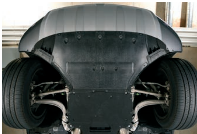
» Slika 4: Spodnji pokrov motorja izdelan iz kompozita z neskončnimi vlakni
