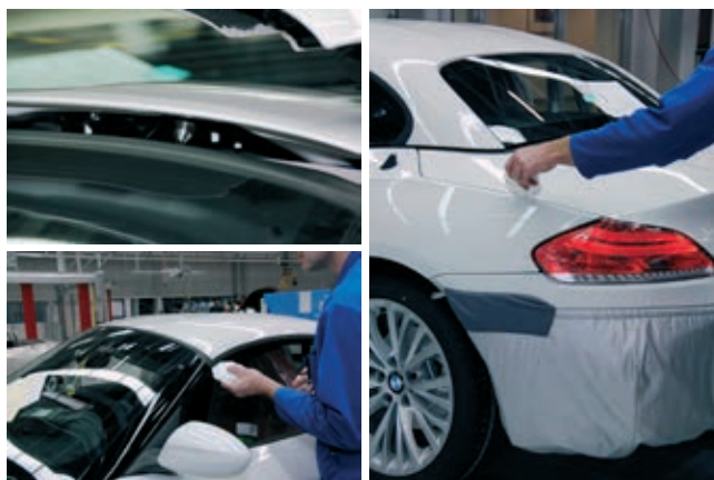
» Slika 13: Sistem TRITOP CM pomaga odgovoriti na visoke optične in funkcionalne zahteve na avtomobilsko industrijo. S prihranki pri naknadnih popravkih pomaga sistem zmanjšati proizvodne stroške in optimizirati delovne procedure.
