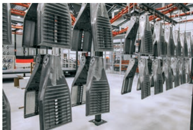
» Alkalni dvokomponentni čistilnik omogoča kvalitetno čiščenje – prikazani deli imajo 100-odstotno hidrofilno površino.
