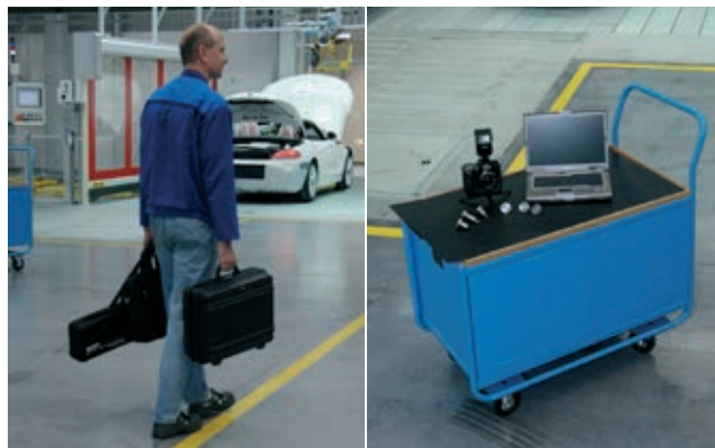
» Slike 6 in 7: Prenosni optični merilni sistem TRITOP CMM dela brez zunanjega izvora energije
