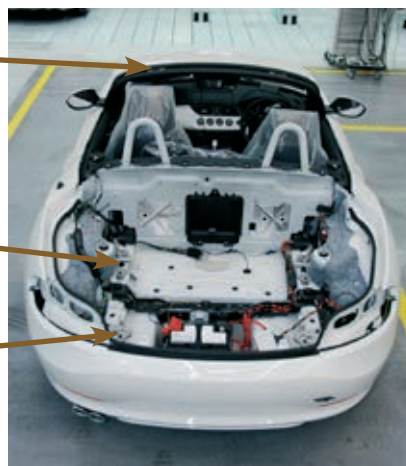
» Slika 1: Okviri za sklapljanje 3-delnega sklopljivega trdnega strešnega modula in nastavljanje položaja proti telesu
