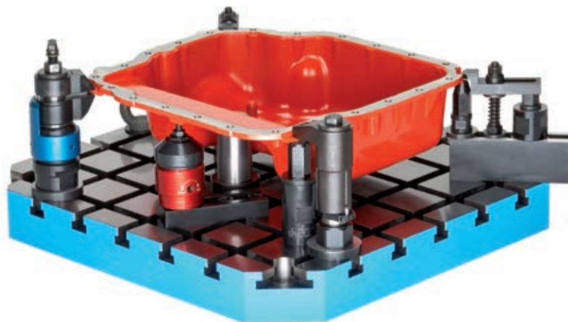
» Slika 2: S kombiniranjem plavajočih vpenjal in podpornih elementov pri frezanju oljnega korita preprečujemo nastajanje vibracij.
