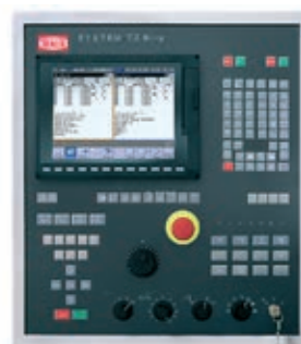
» Zmogljivo produkcijsko krmilje TX8i-p je razširljivo s paketom za 3D-simulacije WinFlexIPSPPlus na zunanjem namiznem/prenosnem računalniku.
