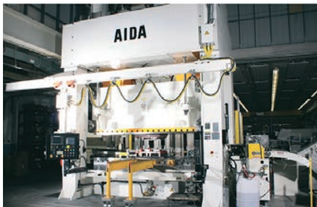
» Skrajšanje časa priprave nove Millerjeve linije za štancanje je rezultat inovacij na celotni liniji. Glavni upravljalni pult je premičen in upravljavcu prihrani sprehode med pripravo. Na pultu so tudi vsi zasloni in gumbi za neoviran dostop do stiskalnice.
