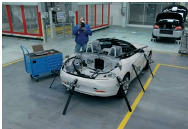
» Slika 9: Proces merjenja neposredno poleg linije za sklapljanje
