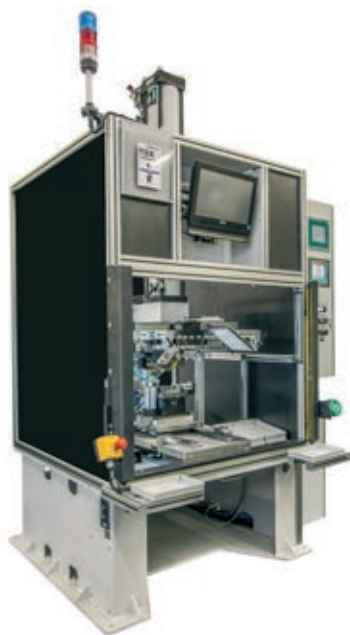
» Stiskalnica TOX® z večtočkovnim orodjem in nadzorom procesa
