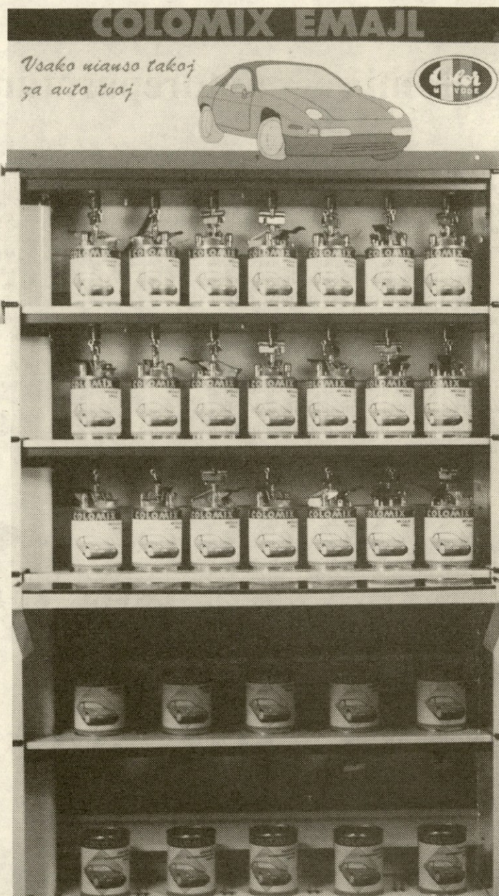
Mešalna naprava za končno izdelavo avtoemajla v željenem barvnem tonu.
