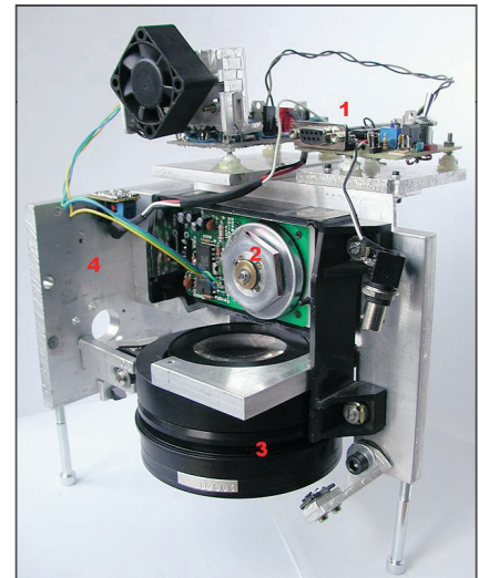
Slika 5. Fotografija prototipa krmilnika in odklanjala žarka rastrskega označevalnika; (1) mikroprocesorska krmilna enota, (2) elektromotor, ki ima na gredi nameščeno šesterokotno zrcalno prizmo, (3) f-Theta leča in (4) aluminijasto ogradje.
