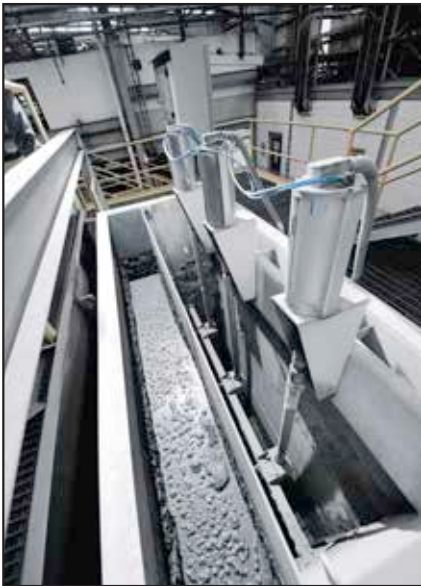
Slika 8. Kompaktni in robustno zaščiteni pnevmatični linearni pogoni z vgrajenim krmilnikom položaja in dajalnikom pomika DFPI za regulacijo zapornih ventilov v flotacijski kadi. Po štirih letih uporabe še brez vzdrževanja in zaustavitve. (Foto: Festo AG & Co. KG)
