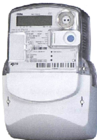
Slika 6. Sodobni gospodinjski elektronski števec električne energije.
