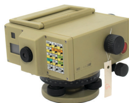
Slika 15: Digitalni nivelir Wild, NA 3000, ser. št. 91725, evid. št. 64 (foto: Mateja Urbas).
