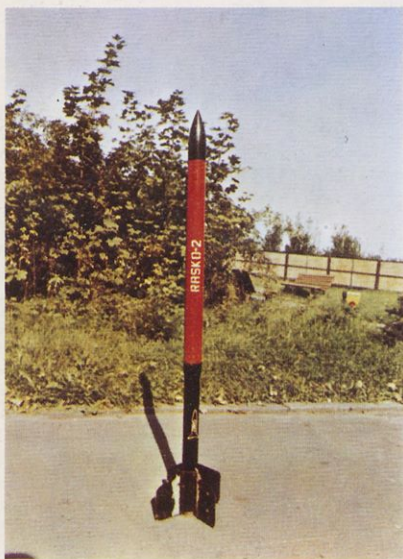
RASKO-2 poljska protitočna raketa
