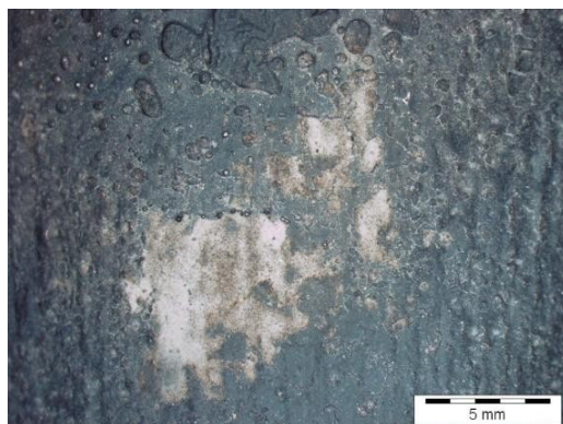
Sl. 5. Ulitek brez sól komponente, očiščen
