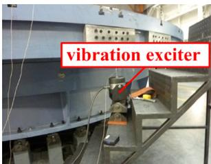
Fig. 10. Sweep test setup
