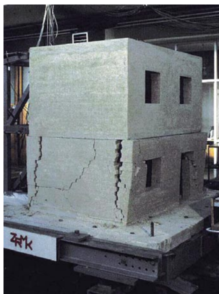
Slika 24 • Med preiskavo na potresni mizi je toga stropna plošča razrinila zidove, ki so stali pravokotno na smer nihanja
