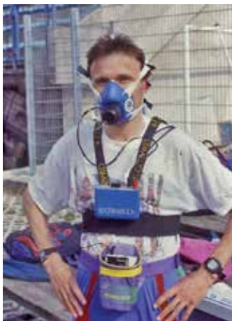
Slika 3. Mirko Vindiš pred Ol v Seulu (1988) na testiranju v Novi Gorici (levo) in Andraž Vehovar na testiranju na Zbiljskem jezeru pred Ol v Atlanti (1996). Oba sta uporabila prenosne naprave za merjenje izmenjave plinov in frekvence srca. Oboje je bilo mogoče spremljati ob robu stadiona ali na obali jezera.
