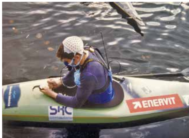
Slika 3. Mirko Vindiš pred Ol v Seulu (1988) na testiranju v Novi Gorici (levo) in Andraž Vehovar na testiranju na Zbiljskem jezeru pred Ol v Atlanti (1996). Oba sta uporabila prenosne naprave za merjenje izmenjave plinov in frekvence srca. Oboje je bilo mogoče spremljati ob robu stadiona ali na obali jezera.
