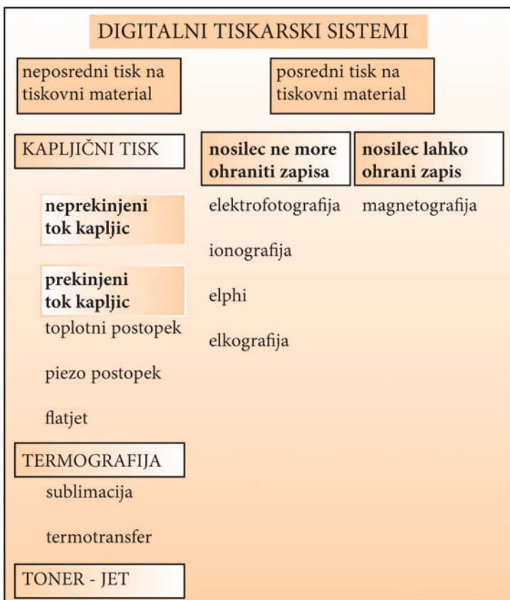
Slika 1. Shema digitalnih tiskarskih sistemov.
