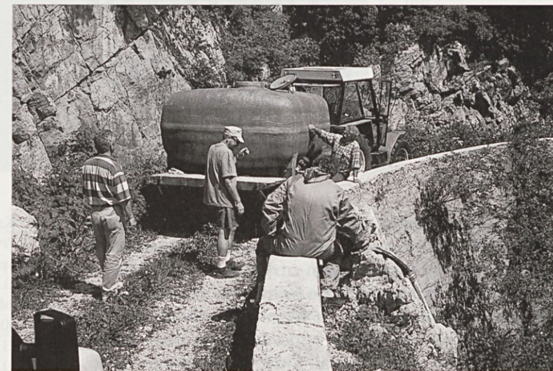
Injiciranje sledila v Belo brezno na Trnovskem gozdu v letu 1995 Foto: Mag. J. Kogovšek
