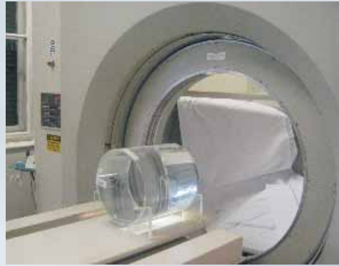
Slika 11: Fantom cilindrične oblike (LKH Graz).
