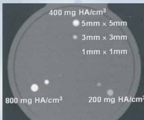
Slika 15: Slika vstavka za telo fantoma, ki vsebuje devet majhnih kalcifikacij (Baert et al., 2004).
