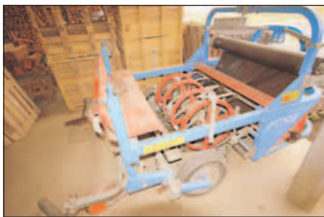
Stroj za sejanje najprej položi folijo proti plevelu in izsuševanju zemlje, nato skoznjo in v zemljo izdolbe luknjo ter v tretji fazi spusti noter sadiko solate.
