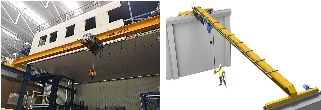
Slika 34: Primera mostnega dvigala
