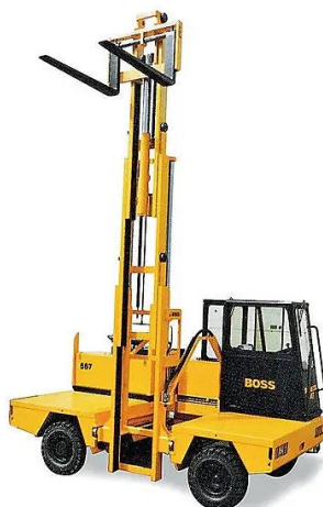
Slika 6: Bočna izvedba viličarja
