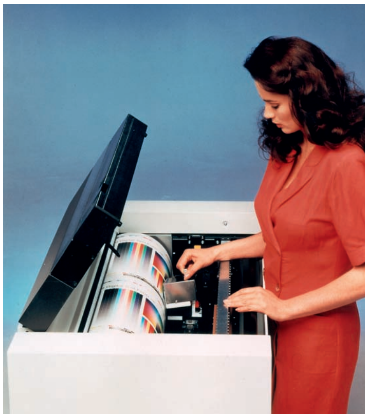
Slika 33. Studiojski tiskarski stroj za kapljični tisk s tiskovno glavo ob tiskovnem valju, na katerega je napet tiskovni material.
