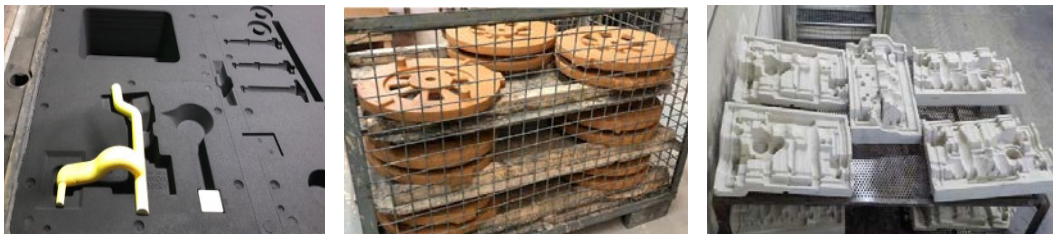
Slika 11. Primeri uporabe anorgansko vezanih jeder za ulitke iz železovih litin
