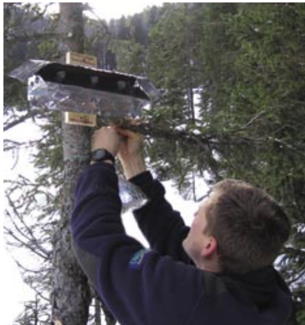
Slika 4: Nameščanje analognega in digitalnega termometra (foto: Darko Ogrin).
