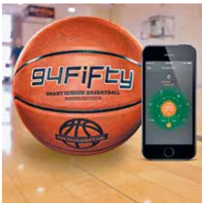
Slika 7. Tehnologija 94Fifty oziroma »pametna« žoga, ki ponuja podatke o izmetnem času, rotaciji žoge in vpadnem kotu žoge v koš
