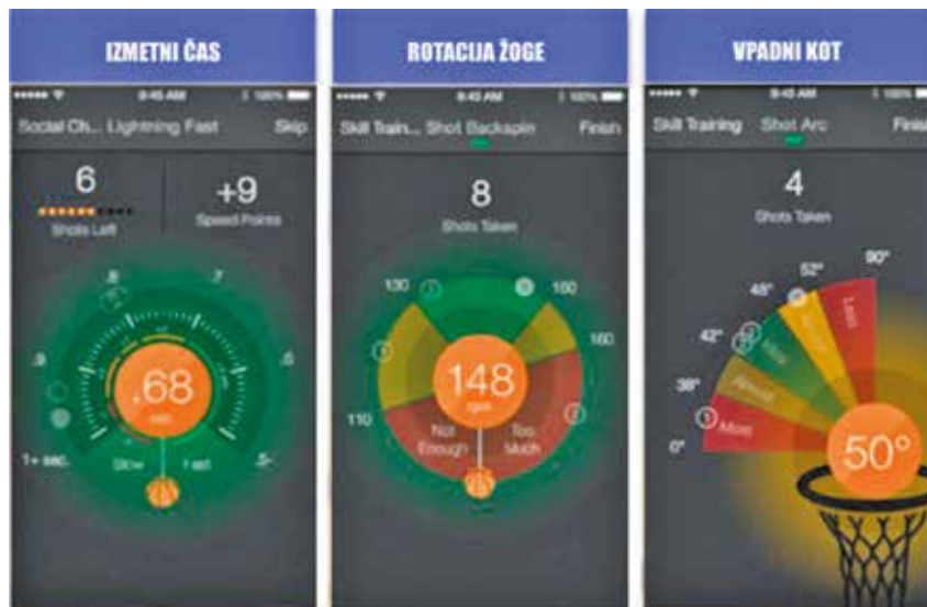
Slika 7. Tehnologija 94Fifty oziroma »pametna« žoga, ki ponuja podatke o izmetnem času, rotaciji žoge in vpadnem kotu žoge v koš
