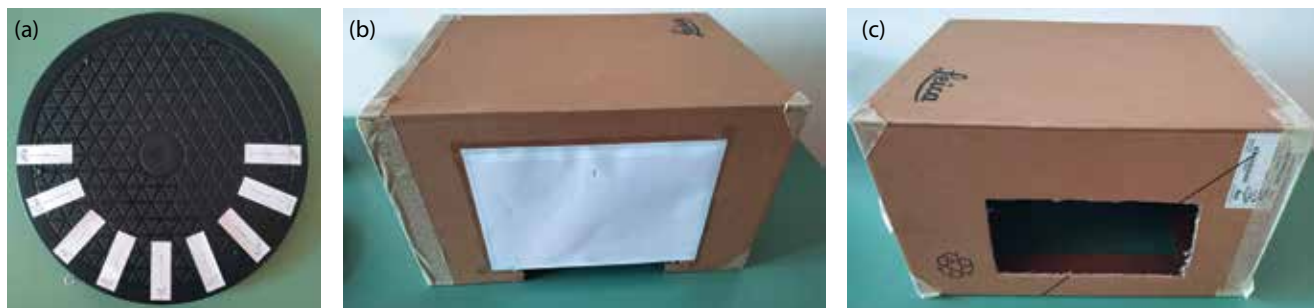
Slika 5: (a) Slika vrtljivega krožnika z označenimi koti zasuka na področju 0 – 180^\circ s korakom 22,5^\circ . (b) Slika zaslona z milimetrskim papirjem. (c) Slika odprtine za svetlobo.
