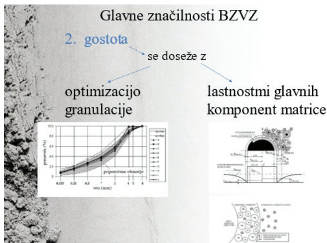
Slika 3. Doseganje visoke gostote betonov zelo visokih zmogljivosti; iz referata z naslovom Drobnozrnati betoni – malte s posebnimi lastnostmi .
