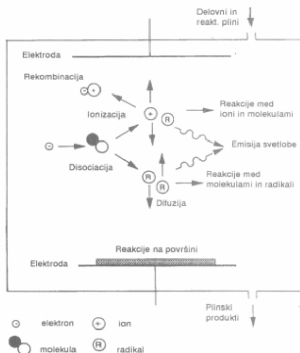
Slika 3 Shematski prikaz reakcij, ki potekajo v plazemskih reaktorjih
