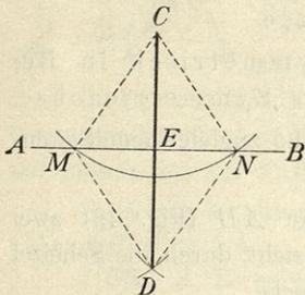
§ 56. Auf eine gegebene Gerade  $AB$  (Fig. 52) von einem außer ihr befindlichen Punkte  $C$  eine Normale zu fällen.
