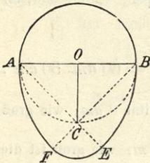
2. Die Eilinie oder das Oval (Fig. 190) ist aus einem Halbkreise und einem länglichen Gebilde, das einer halben Ellipse ähnlich ist, zusammengesetzt.
