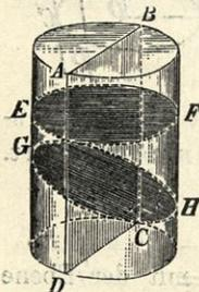
so ist die Schnittfläche ein Rechteck  $ABCD$  oder ein schiefes Parallelogramm, je nachdem der Zylinder gerade oder schief ist.
