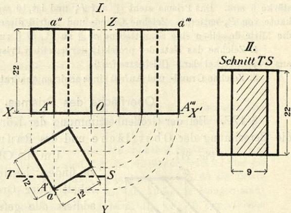
In Fig. 210, I und II, erscheinen Teile der Oberfläche sowie Kanten dieses Prismas in der horizontalen und vertikalen Projektion dargestellt. Was lehren die Projektionen der Seitenflächen?
