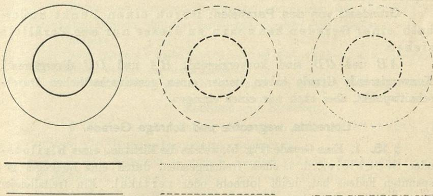
sie ohne Unterbrechung, oder durch Punkte, oder durch Striche und Punkte dergestellt sind. (Fig. 3.)
