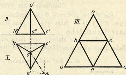
Die Oberfläche des Tetraeders besteht aus 4 gleichseitigen Dreiecken; bezeichnet man die Maßzahl der Kante mit  $s$ , so ist
