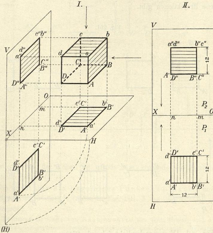
von denen der Rauminhalt eines Körpers abhängt. Der **Grundriß** und **Aufriß** eines Körpers enthält demnach die geometrische Darstellung seines Rauminhaltes oder Volumens.
