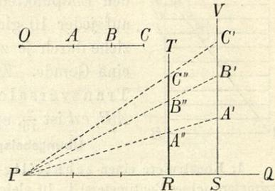
Wären die gegebenen Strecken in dem Verhältnisse 3:4 zu vergrößern, so würde man sie auf die nähere Normale  $RT$  auftragen; auf der Normalen  $SV$  erhielte man dann die verhältnismäßig vergrößerten Strecken.
