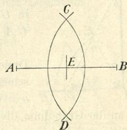
ihren Endpunkten mit demselben Halbmesser nach oben und unten Kreisbogen, die einander in zwei Punkten schneiden, und ziehe durch die beiden Punkte eine Gerade; diese Gerade halbiert die gegebene Strecke.
