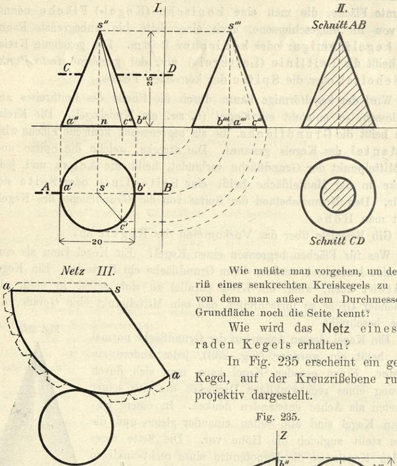
Wie müßte man vorgehen, um den Aufriß eines senkrechten Kreiskegels zu finden, von dem man außer dem Durchmesser der Grundfläche noch die Seite kennt?
