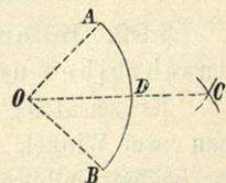
konstruiere den gefundenen Winkel am Mittelpunkte und trage die durch seine Schenkel abgeschnittene Sehne in der Peripherie auf.
