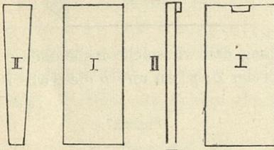
2. Bei Gewölben kleinerer Gattung werden sogenannte Keilziegel (Fig. 290) angewendet.
