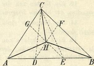
Man teile eine Seite  $AB$  in den Punkten  $D$  und  $E$  in drei gleiche Teile und ziehe  $CD$  und  $CE$ ; dann sind die Dreiecke  $ACD$ ,  $DCE$ ,  $BCE$  gleich. Zieht man nun  $DF \parallel AC$  und  $EG \parallel BC$ , so sind die vom Durchschnittspunkte  $H$  aus gezogenen Geraden  $AH$ ,  $BH$ ,  $CH$  die gesuchten Teilungslinien.
