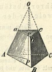
Die Höhen ähnlicher Pyramiden verhalten sich wie zwei gleichliegende Seitenkanten (1) oder wie zwei entsprechende Grundkanten (2).
