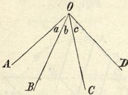
Denn würden alle Kantenwinkel zusammen  $4 R$  betragen, so müßten alle Seitenebenen in eine einzige Ebene übergehen und könnten daher keine Ecke bilden. Je größer die Summe der von den Kanten eingeschlossenen Winkel  $AOB, BOC, COD$  (Fig. 198) ist, desto flacher ist die Ecke.
