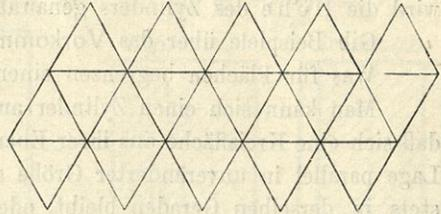
Die Konstruktion des Netzes eines Ikosaeders ist aus Fig. 224 ersichtlich.
