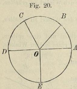
Der Punkt  $O$ , von dem alle Punkte der Kreislinie gleich weit abstehen, heißt der **Mittelpunkt** oder das **Zentrum**; die Länge der ganzen Kreislinie selbst wird der **Umfang** oder die **Peripherie** des Kreises genannt.
