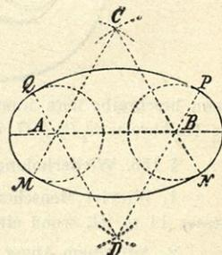
*b)* Man beschreibe (Fig. 189) aus  $A$  und  $B$  mit einem Halbmesser, der kleiner als die Hälfte von  $AB$  ist, zwei Kreise und dann aus denselben Punkten mit  $AB$
