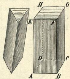
Eine Ebene ( $BB'E'E$  in Fig. 204), die durch zwei nicht unmittelbar aufeinander folgende Seitenkanten gelegt wird, heißt ein Diagonalschnitt des Prismas.
