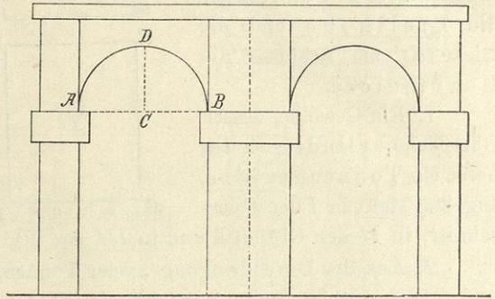
dieser ein Rundbogen, voller Bogen oder römischer Bogen; die Strecke  $AB$  nennt man die Spannweite, die Punkte  $A$  und  $B$  die Anläufe, die in  $C$  auf  $AB$  errichtete Normale  $CD$  die Pfeilhöhe und  $D$  den Schluß des Bogens; die in  $A$  und  $B$  errichteten Senkrechten  $AE$  und  $BF$  heißen die Gewände des Bogens.
