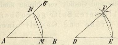
7. Einen Winkel  $BAC$  (Fig. 40) zu übertragen, d. i. einen Winkel zu zeichnen, der dem Winkel  $BAC$  gleich ist.
