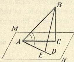
Der Winkel, den eine Gerade mit ihrer Projektion auf einer Ebene einschließt, bildet den **Neigungswinkel** der Geraden zur Ebene (Fig. 195,  $\sphericalangle BAC$ ).
