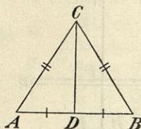
Es seien in dem Dreiecke  $ABC$  (Fig. 45) die Seiten  $AC$  und  $BC$  einander gleich. Man ziehe  $CD$  als Symmetrale des Winkels  $C$  und klappe das Dreieck  $ADC$  um diese Symmetrale um; es fällt  $A$  auf  $B$ ,  $AC$  auf  $BC$  und  $DA$  auf  $DB$ ; daher ist  $\sphericalangle A = \sphericalangle B$ . Wenn also im Dreiecke  $ABC$  die Seite  $AC = BC$  ist, so muß auch der Winkel  $B = A$  sein; d. h.:
