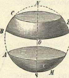
jeder der beiden Kugelabschnitte eine Halbkugel (Fig. 246). Die gekrümmte Oberfläche eines Kugelabschnittes  $ASM$  (Fig. 247) heißt eine Kugelmütze oder Kalotte. Dreht sich ein Ausschnitt (Sektor) eines größten Kugelkreises um einen
