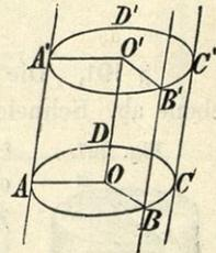
Jeder mit der Ebene der Leitlinie  $\parallel$  gelegte Schnitt einer zylindrischen Fläche ist eine Kreislinie, die mit der Leitlinie gleichen Halbmesser hat. (Veranschaulichung!)
