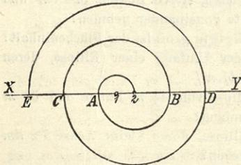
Um eine Spirale zu erhalten, beschreibt man aus dem Punkte 1 der Geraden  $XY$  einen Halbkreis  $A2$  nach oben, dann aus 2 mit dem Halbmesser  $2A$  einen Halbkreis nach unten und so fort weitere Halbkreise aus 1 nach oben, aus 2 nach unten.
