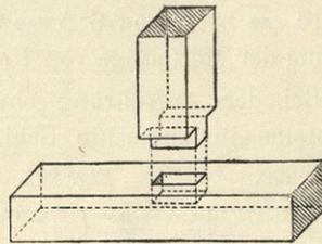
Fig. 286 stellt eine Art von Verzapfung dar, wie solche insbesondere bei Dachkonstruktionen vorkommt; *a* heißt der Zapfen und *b* die Gabel oder Gurgel.
