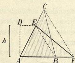
Man errichte  $AD = h$  normal auf  $AB$ , ziehe  $DE \parallel AB$ , dann die  $EB$  und damit parallel die  $CF$ . Verbindet man nun  $E$  und  $F$  durch eine Strecke, so ist  $\triangle AEF = \triangle ABC$ . ( $h < H, h > H$ .)
