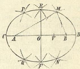
Es ist eine Ellipse zu konstruieren, von welcher die beiden Achsen  $AB$  und  $CD$  gegeben sind.
