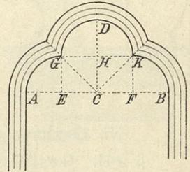
5. Teilt man (Fig. 303) die Spannweite in vier gleiche Teile, errichtet in den drei Teilungspunkten  $ECF$  Normale und macht  $EG = CH = FK = AE$ , so bilden die aus  $E, H$  und  $F$  mit dem Halbmesser  $AE$  beschriebenen, in den Punkten  $G$  und  $K$  zusammenstoßenden drei Kreisbogen die Bogenlinie  $AGDKB$ , die ein Kleebogen heißt.
