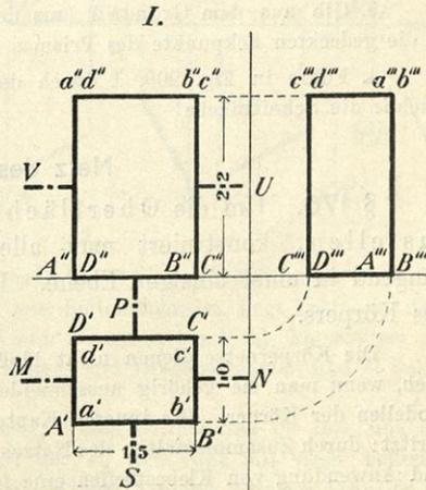
Der Schnitt des Prismas mit Hilfe der Schnittebene  $MN$  (Fig. 208, I) ist der Längsschnitt, eine Fläche  $MN$  (in Fig. 208, II) von der Größe und Gestalt des Aufrisses, die Höhe und Länge des Prismas enthält; der
