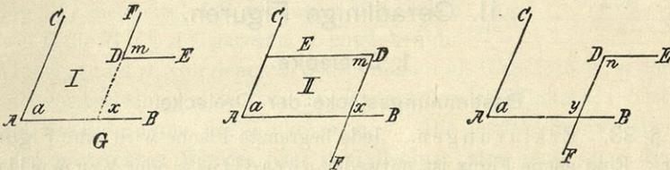
In III haben die Winkel  $a$  und  $n$  auch paarweise parallele Schenkel, es ist jedoch nur ein Paar paralleler Schenkel nach derselben Seite, das andere Paar aber nach entgegengesetzten Seiten gerichtet. Da  $a + y = 2R$  als Anwinkel und  $n = y$  als Wechselwinkel ist, so ist auch  $a + n = 2R$ .
