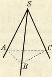
Ist (Fig. 197)  $S$  der Scheitel der Ecke und sind  $SA, SB, SC$  deren Kanten, so bezeichnet man die körperliche Ecke durch  $SABC$  oder durch  $S$ ; die Winkel  $ASB, BSC, CSA$  sind deren Kantenwinkel.
