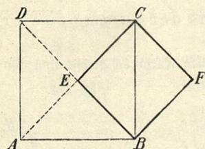
6. Ein Quadrat zu konstruieren, das die Hälfte eines gegebenen Quadrates  $ABCD$  (Fig. 177) ist.
