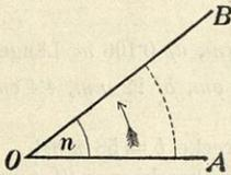
Einen Winkel (Fig. 11) bezeichnet man entweder 1.) mit einem einzigen Buchstaben ( $n$ ), den man zwischen die Schenkel setzt, oder 2.) mit dem Buchstaben am Scheitel ( $O$ ), oder 3.) mit drei Buchstaben ( $\sphericalangle AOB$  oder  $\sphericalangle BOA$ ), von denen der am Scheitel stehende immer in die Mitte gesetzt wird; der Winkel heißt daher: Winkel  $n$  oder Winkel  $O$  oder Winkel  $AOB$  oder Winkel  $BOA$ .
