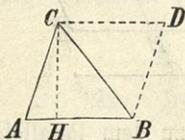
gleiche Höhe hat; man braucht nur durch zwei Eckpunkte *B* und *C* mit den gegenüberliegenden Seiten Parallele zu ziehen. Um den Flächeninhalt des Parallelogramms zu erhalten, muß man die Grundlinie mit der Höhe multiplizieren; zur Bestimmung der Dreiecksfläche wird man daher auch die Grundlinie mit der Höhe multiplizieren, jedoch von diesem Produkte nur die Hälfte nehmen.
