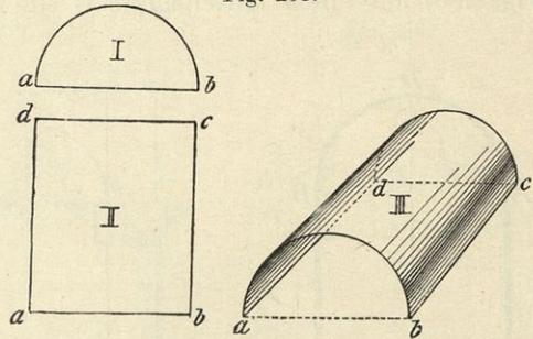
1. Ein Gewölbe, dessen Oberfläche zylindrisch ist, heißt ein Tonnengewölbe.
