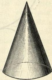
Ist in einem geraden Kegel die Seite dem Durchmesser der Grundfläche gleich, so heißt er ein **gleichseitiger Kegel**.
