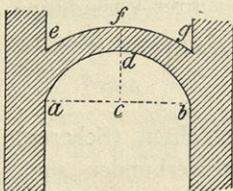
Stellt Fig. 292 den Querschnitt oder das Profil eines Gewölbes dar, so heißen die Mauern, auf die sich das Gewölbe stützt, die Widerlager und die Punkte *a* und *b*, in denen das Gewölbe an den Widerlagern beginnt, die Anläufe; den
