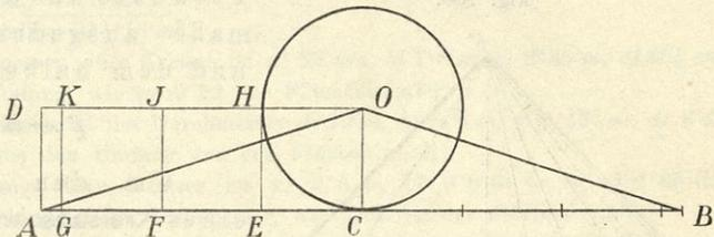
Macht man  $CE = EF = FG$  und zieht die Normalen auf  $AB$ , so erhält man die Figuren  $COHE$ ,  $EHJF$ ,  $FJKG$  und  $GKDA$ , von denen die drei ersten Figuren Quadrate über dem Halbmesser des Kreises sind und die letzte Figur der 7. Teil eines solchen Quadrates ist. Folglich besteht das Rechteck  $ACOD$  aus  $3\frac{1}{7}$  Quadraten über dem Halbmesser des Kreises und da dieses Rechteck dem gegebenen Kreise flächengleich ist, so gilt der Satz:
