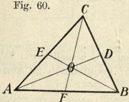
Die drei **Mittellinien** eines Dreieckes schneiden sich in **einem** und **demselben** Punkte, welcher jede Mittellinie so teilt, daß der an einer Ecke liegende Abschnitt doppelt so groß ist als der andere. Der Schnittpunkt der Mittellinien eines Dreieckes heißt **Schwerpunkt** des Dreieckes.
