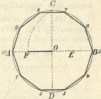
Man ziehe (Fig. 137) zwei aufeinander normale Durchmesser  $AB$  und  $CD$ , halbiere den Halbmesser  $OB$  in  $E$  und beschreibe aus  $E$  mit dem Halbmesser  $EC$  einen Bogen, der den Halbmesser  $OA$  in  $F$  schneidet; die Strecke  $CF$  läßt sich dann genau fünfmal als Sehne im Kreise herum auftragen, die Strecke  $OF$  ist die Zehneckseite.
