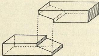
Bei der schiefen Überplattung (Fig. 279) ist die Länge wie bei der vorhergehenden; die Höhe der lotrechten Stoßflächen beträgt ungefähr  $\frac{1}{4}$  der Balkenhöhe. Bei der verzahnten Überplattung (Fig. 280) beträgt die Höhe des Zahnes gleichfalls ungefähr  $\frac{1}{4}$  der Balkenhöhe.
