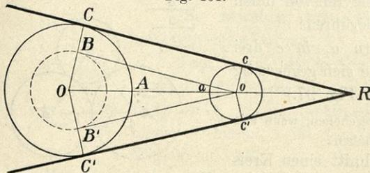
Verlängert man dann die Halbmesser  $OB$  und  $OB'$  bis zum Durchschnitte des gegebenen Kreises in  $C$  und  $C'$  und zieht  $oc \parallel OC$  und  $oc' \parallel OC'$ , so sind die Geraden
