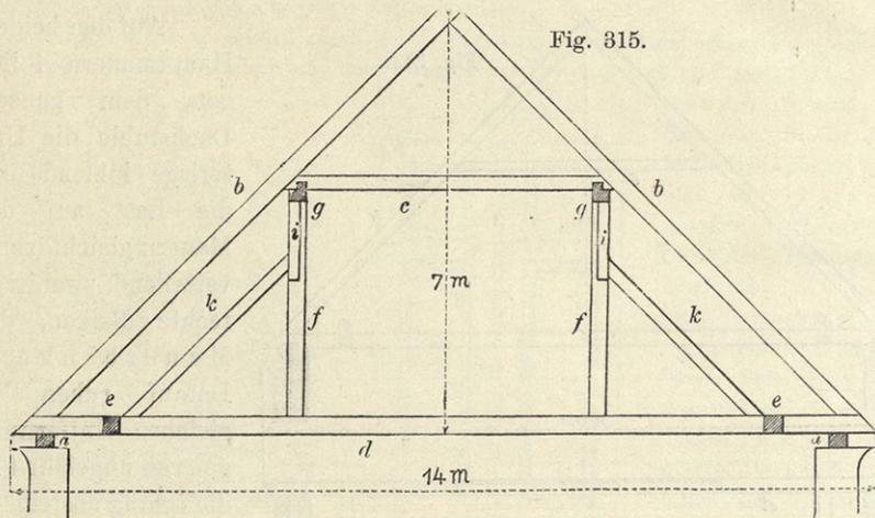
den Kahlbalken unterstützen, und an ihrem oberen Ende die Pfetten *g*, die nach der Länge des Daches laufen und die einzelnen Gespärre verbinden. Die Pfettenbüge *i* sind bestimmt, den Pfetten eine größere Tragfähigkeit zu geben, während die lotrechte Stellung der Stuhlsäulen durch die Fußbänder *k* gesichert wird.
