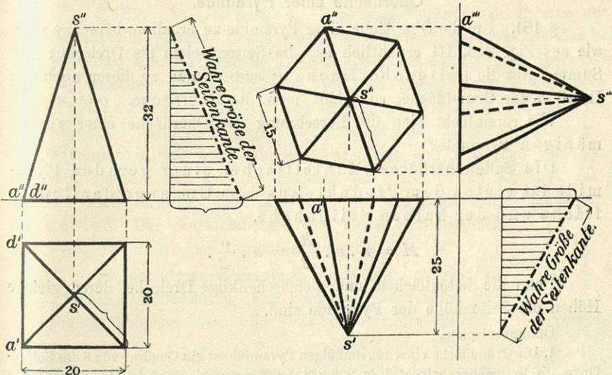
vertikalen  $PE$ . Zur Darstellung der Netze dieser beiden Körper ist die Bestimmung der wahren Größe einer Seitenkante (Erzeugenden) erforderlich.
