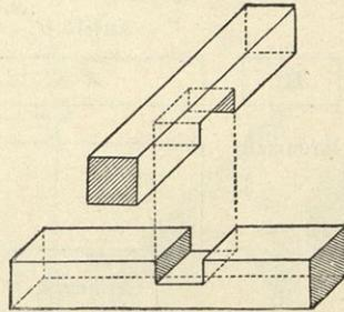
sprechende Vertiefung eines anderen Balkens eingelassen, so heißt eine solche Verbindung im ersten Falle eine Einlassung (Fig. 284), im zweiten eine Verzapfung (Fig. 285).
