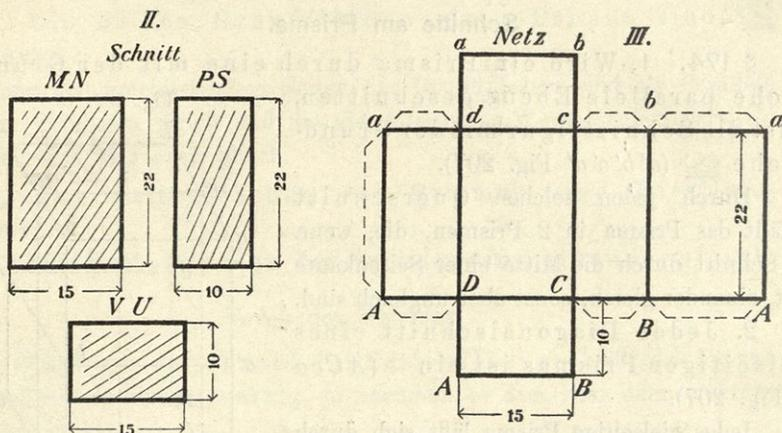
Schnitt mittelst der Schnittfläche  $PS$  (in Fig. 208, I) gibt eine Figur (einen Längsschnitt  $PS$  in Fig. 208, II) von der Größe und Gestalt der Seitenansicht des Prismas, woraus Höhe und Breite des Prismas entnommen werden kann. Die Schnittfiguren werden durch Schraffieren besonders hervorgehoben.
