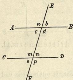
Ein äußerer und ein innerer Winkel auf derselben Seite der Schneidenden und an verschiedenen Scheiteln heißen **Gegenwinkel**:  $a$  und  $m$ ,  $b$  und  $n$ ,  $c$  und  $o$ ,  $d$  und  $p$ .
