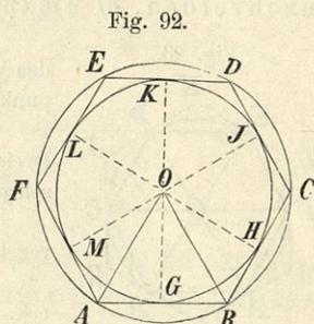
**Zusatz.** Die Seite des einem Kreise eingeschriebenen regelmäßigen Sechseckes ist gleich dem Halbmesser des Kreises (§ 89).
