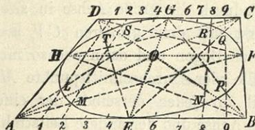
Teilt man dann jede der zwei Parallelseiten in 10 gleiche Teile, verbindet die ersten zwei und die letzten zwei Teilungspunkte durch Strecken und zieht auch von den Punkten  $E, F, G, H$  zu den gegenüberstehenden Eckpunkten des Trapezes Strecken, so liegen die Durchschnitte  $L, M, N, P, Q, R, S, T$  dieser und der früher gezogenen Strecken in der Ellipse. Man hat also zur Bestimmung der Ellipse zwölf Punkte.
