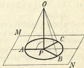
Die Normale ist die kürzeste unter allen Strecken, die von einem Punkte außerhalb einer Ebene zu dieser gezogen werden können. Denn: ist  $OP \perp$  Ebene  $MN$  und  $OA$  irgend eine andere von  $O$  zu der Ebene geneigte Strecke, so ist in dem rechtwinkligen Dreiecke  $APO$  die Kathete  $OP$  kleiner als die Hypotenuse  $OA$ .
