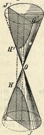
Die vorstehend angeführten Schnittlinien lassen sich auf sehr anschauliche Weise darstellen, wenn man ein kegelförmig zugespitztes Glas zum Teile mit einer gefärbten Flüssigkeit füllt, dann oben schließt und die Richtung seiner Achse ändert.
