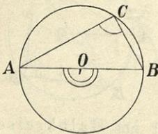
§ 88. Ein Peripheriewinkel  $ACB$  (Fig. 87) als ein Winkel im Halbkreise muß  $90^\circ$  betragen, weil der ihm zugehörige Zentriwinkel als gestreckter  $180^\circ$  enthält.
