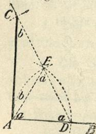
Begründung: Vermöge der Konstruktion ist das Dreieck  $ADE$  gleichseitig und das Dreieck  $ACE$  gleichschenkelig. Im  $\triangle ADE$  ist daher jeder der drei Winkel  $a = 60^\circ$ ; im  $\triangle ACE$  ist jeder der zwei gleichen Winkel  $b$  an der Grundlinie die Hälfte des Außenwinkels  $a$ , also  $b = 30^\circ$ . Mithin ist Winkel  $BAC = a + b = 60^\circ + 30^\circ = 90^\circ$  und daher  $AC \perp AB$ .
