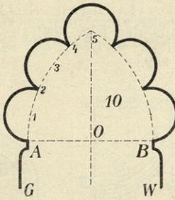
8. Der maurische oder arabische Bogen. Die Konstruktion desselben ist aus Fig. 306 ersichtlich.
