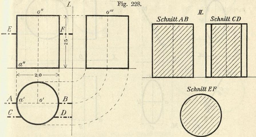
und den Parallelschnitt  $EF$ , in III das Netz desselben dar. Der Grundriß gibt die Grundfläche, der Aufriß (oder der Kreuzriß) die Höhe des Zylinders an.
