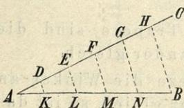
Es sei die Strecke  $AB$  (Fig. 74) z. B. in 5 gleiche Teile zu teilen. Man ziehe durch  $A$  eine andere Gerade  $AC$  von beliebiger Richtung und Länge und trage darauf von  $A$  aus 5 beliebige gleiche Teile auf. Verbindet man den Endpunkt  $H$  des fünften Teiles mit  $B$  durch die  $HB$  und zieht durch  $D, E, F, G$  Parallele mit  $HB$ , so teilen diese auch die  $AB$  in 5 gleiche Teile  $AK, KL, LM, MN, NB$  (§ 69).
