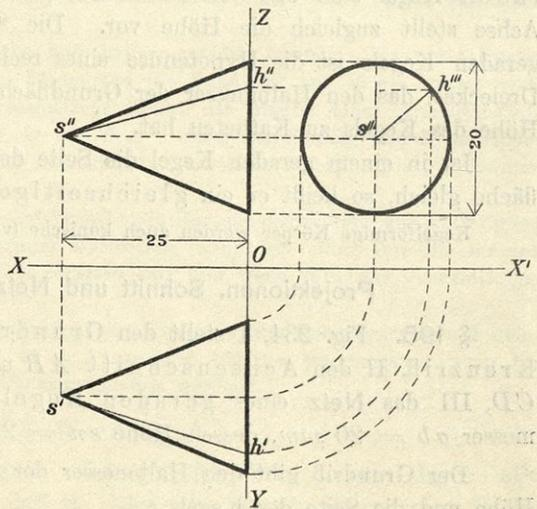
In Fig. 236, I sind der Grund- und Aufriß eines hohlen geraden, auf der  $P_1$  normal auf der Spitze stehenden Kegels, in II der Achsenschnitt  $AB$  und der Parallelschnitt  $CD$  dargestellt.
