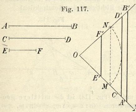
der einer Strecke von drei beliebig angenommenen aber gleichen Teilen gleichkommt, einen Bogen, der die  $OX$  in  $M$  schneidet; aus  $M$  beschreibt man mit einem Halbmesser, der vier solchen Teilen entspricht, einen Bogen, der den früheren in  $N$  durchschneidet; zieht man nun durch  $O$  und  $N$  die Gerade  $OY$  von unbestimmter Länge, so  $X$  ist  $XOY$  der Proportional-
