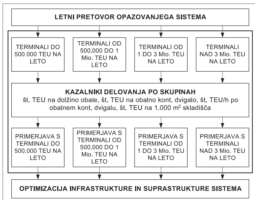
Slika 3: Simulacijski model za pristaniške kontejnerske terminale
