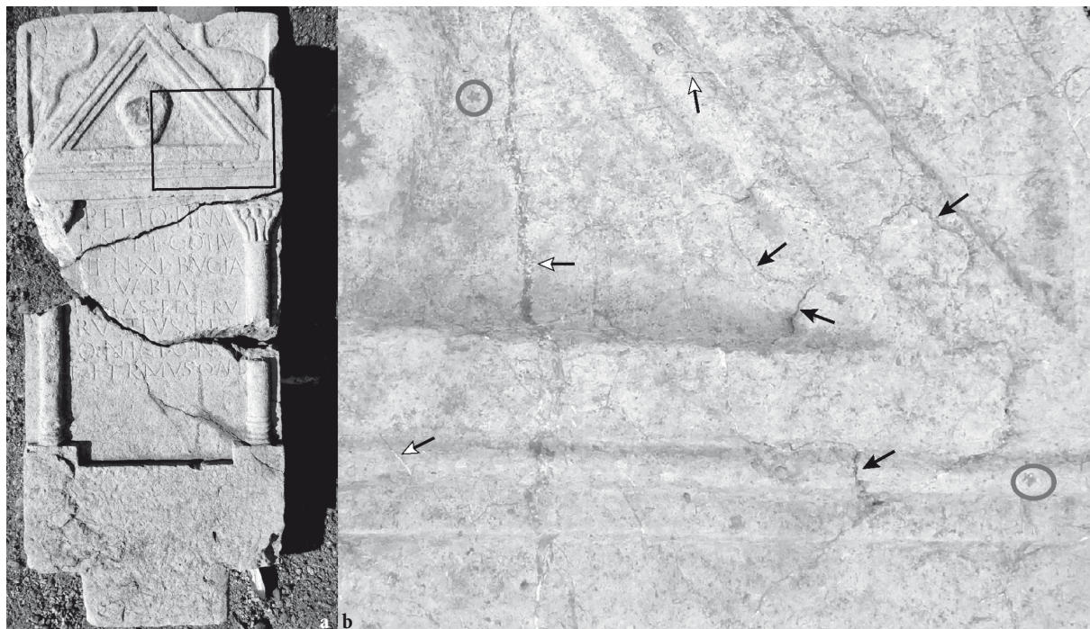
Sl. 3: Nagrobnik za Petona z Iga. a – Nagrobnik z vidno debelejšo kalcitno žilo vzdolž daljše osi. b – Detajl z vidnimi večjimi peterokrakimi krinoidnimi ploščicami (sivimi krogi), različnimi sistemi kalcitnih žilic (bele puščice) in disolucijskimi šivi (črne puščice). (Foto: Matija Lukić [a], Anja Ragolič [b])
