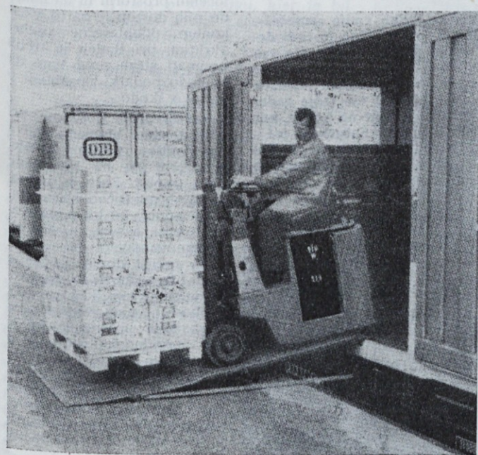
Istovarjanje iz kontejnerja s pomočjo viličarja in paletnega sistema
