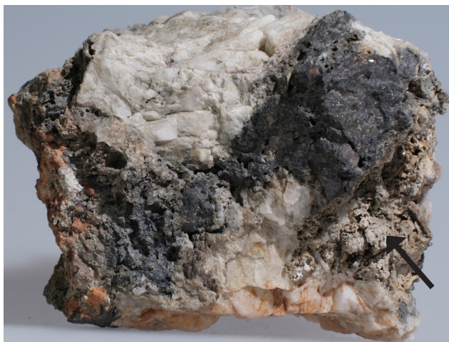
Sl. 3. Fotografija delno oksidiranega arzenopirita (sivo) in verjetno skorodita (puščica) v kremenovi žili, rudišče Znojile. Dolžina vzorca znaša 7 cm (foto: Ž. Šparemblek).
