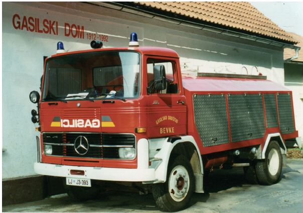
Gasilsko vozilo Mercedes BLP 1113 s cisterno za prevoz pitne vode
