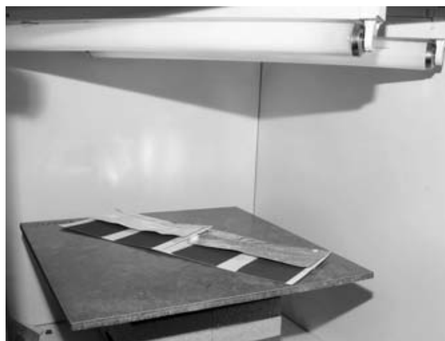
Slika 2: UV-A-svetilki v komori, namenjeni za raziskave fotokatalitsko aktivnih snovi; spektralno obsevanost smo merili na razdalji 20 cm od svetilke na vodoravni površini.
