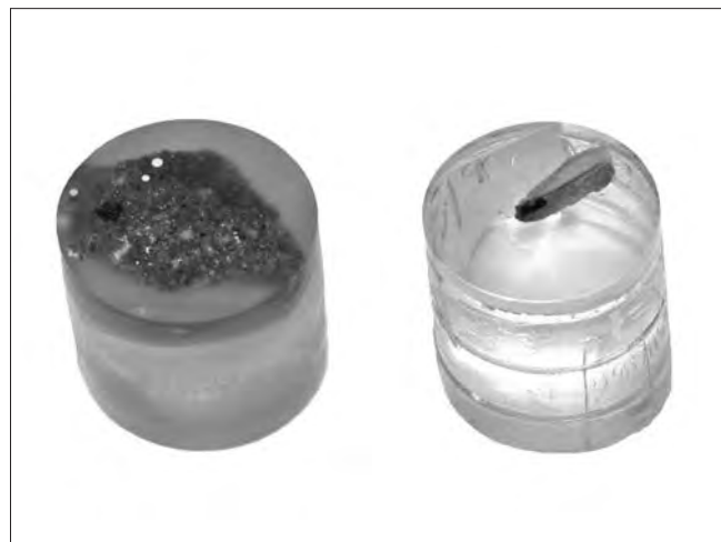
Obrušena in spolirana vzorca ometa in barvnih plasti v poliestrski smoli.
