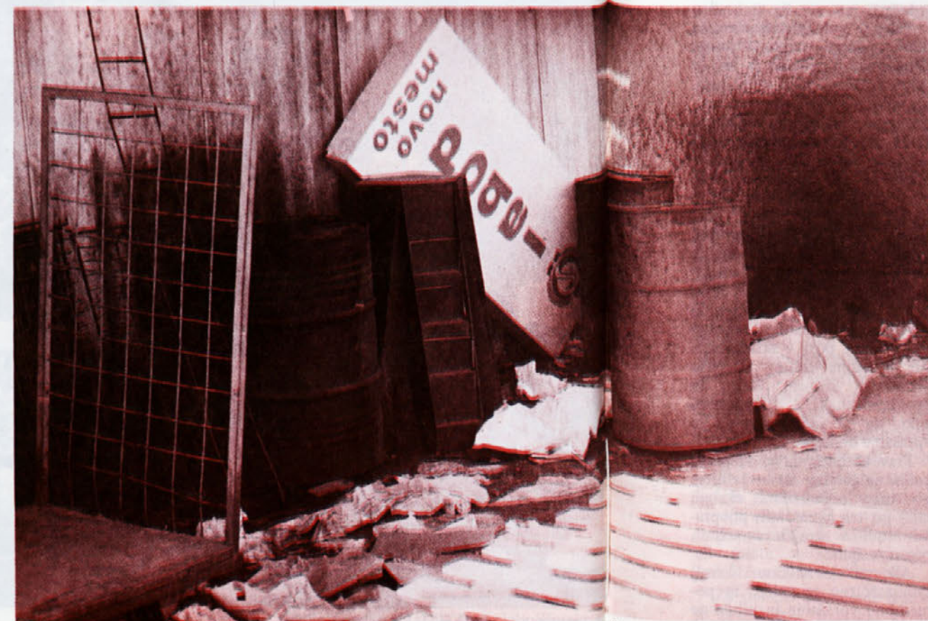
Malomarno ravnanje z odpadnimi olji in nesnaga sta lahko vzrok samovžiga, eksplozije, požara. Znova je potrebno poudariti, da bi morali sode z odpadnimi olji skladiščiti ločeno od lahko-vnetljivih materialov in da bi moral biti zagotovljen sproten odvoz.
