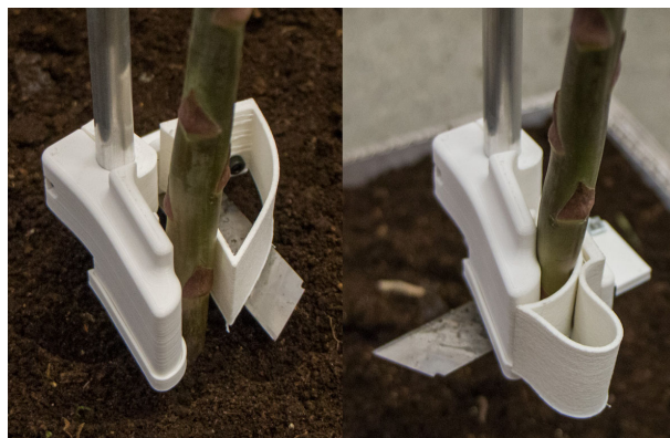
Slika 7: Fotografiji odprtega ter zaprtega prijemala ob pobiranju šparglja. Med prijemanjem rezilo špargelj odreže. Mehki del prijemala (3D natisnjen z materialom TPU) primerno stisne špargelj ne glede na njegovo debelino.
