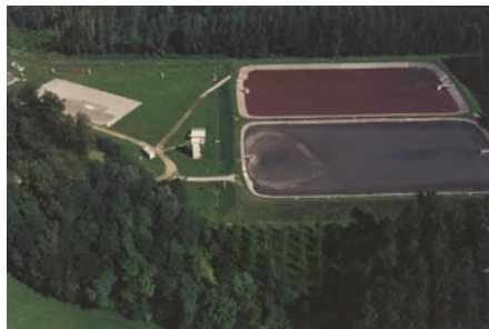
Slika 14 • Farma Podgrad z rezervoarjem stabilizirane gnojivke in črpalnicem za gnojenje in namakanje 400 ha
