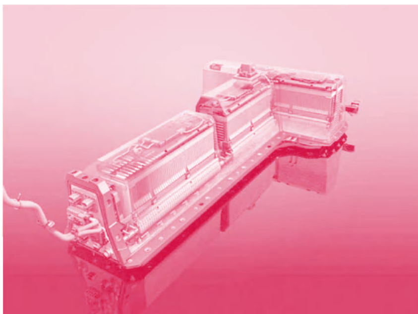
Takšna litij-ionska baterija je vgrajena v električni avtomobil volt ameriškega proizvajalca Chevrolet. (Vir: internet)
