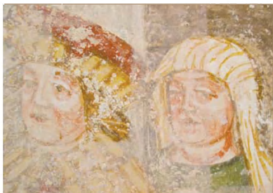
Bodovlje, cerkev sv. Petra. Poizkus odstranjanja prahu s stenskih slik Jerneja iz Loke. Vidne so poškodbe barvne plasti in slikovnega ometa. (dokumentacija: TRIPTIH d. o. o., julij 2008)
