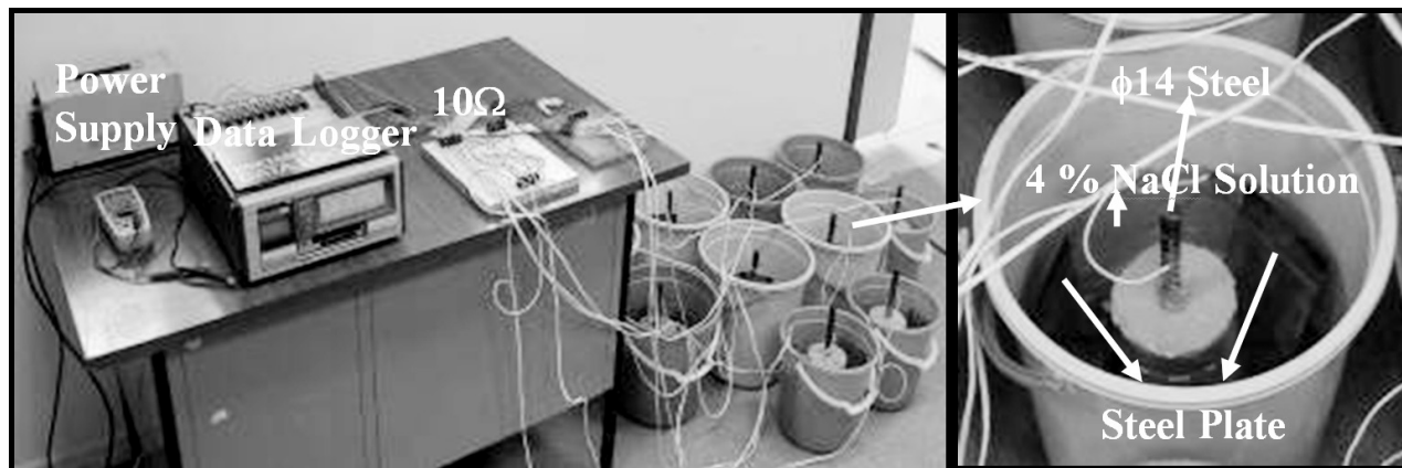
Figure 2: Setup for the impressed voltage test Slika 2: Skica pospešenega napetostnega preizkusa
