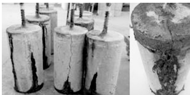
Figure 6: Damaged specimens after the impressed voltage test Slika 6: Poškodovani vzorci po pospešenem napetostnem preizkusu
