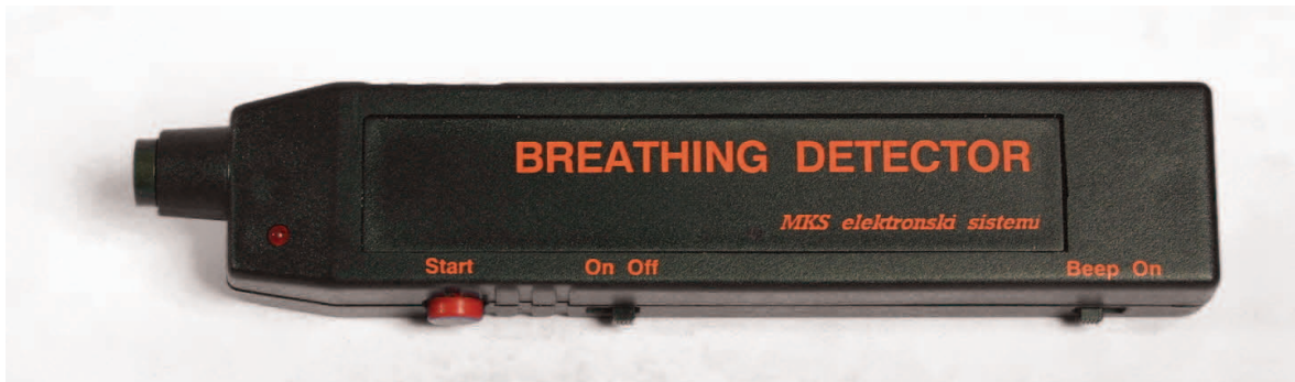
slika 3: Detektor dihanja za ugotavljanje pretoka izdihanega zraka.
