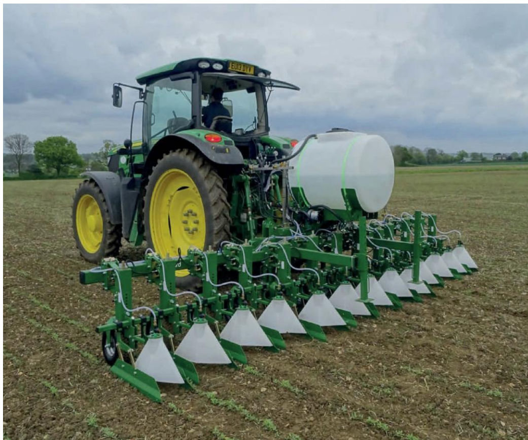
SLIKA 26: Sodobna škropilnica za škropljenje pod ščitom (podjetje Garford, Velika Britanija)
