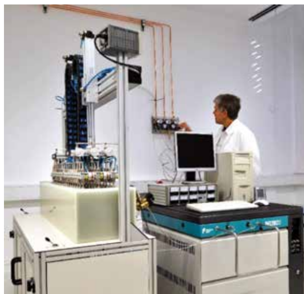
Slika 2. Masni spektrometer Finnigan MAT DELTA plus z dvojnim uvajalnim sistemom in avtomatskim \text{H}_2\text{-H}_2\text{O} in \text{CO}_2\text{-H}_2\text{O} ekvilibratorjem HDOEQ48 (foto: arhiv IJS)
