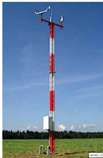
Slika 1. Lomljiv drog za veter na letališču s podvojenima merilnikoma vetra. Na fotografiji je na desni strani ultrazvočni (UZ) anemometer, na levi pa klasični mehanski anemometer s šalčkami in dajalnikom smeri. Barve in barvni vzorci na drogu so tudi predpisani oziroma standardizirani.
