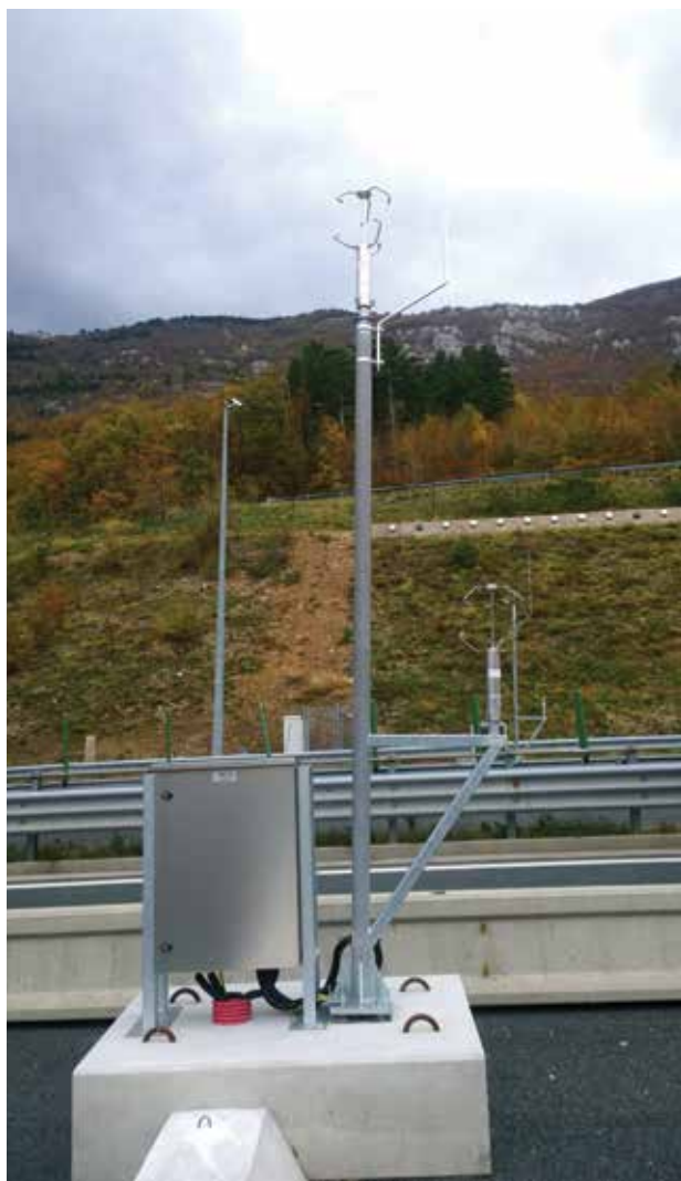
Slika 1. 3D-ultrasonični merilniki na vipavski hitri cesti (foto: Boštjan Grašič, MEIS)
