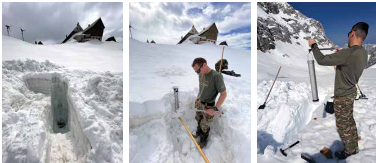
Slika 2. Meritev gostote snežne odeje na Kredarici. Za celotno snežno odejo je treba skopati jama do tal. Ob koncu zimske sezone spomladi 2024 je bila jama globoka tri metre in pol.
