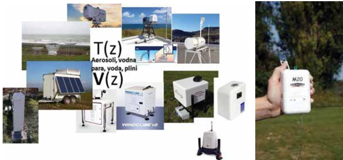
Slika 1. Levo: primeri različnih vrst merilnikov za daljinsko zaznavno ozračja s tal, ki merijo profile temperature, vodne pare, vetra in aerosolov. Desno: primer operativne radiosonde, ki se v Ljubljani spušča vsak dan v jutranjem času s pomočjo balona.
