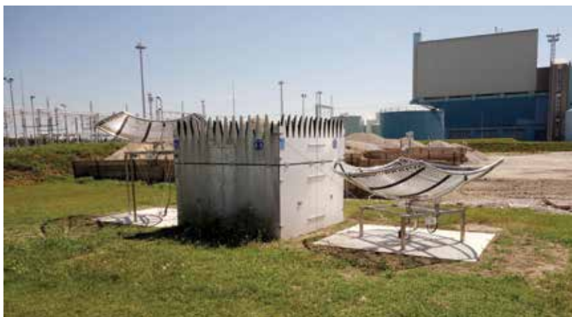
Slika 1. RASS na lokaciji pri Nuklearni elektrarni Krško, vključuje tudi SODAR (3. generacijo) (foto: Brane Ferk, NEK)
