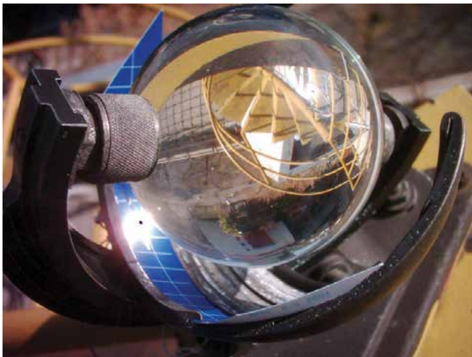
Slika 3. Heliograf je inštrument za merjenje trajanja sončnega obsevanja. Pravzaprav je to idealen registrator, saj Sonce zagotavlja tako uro kot tudi energijo za registracijo. Skrbno pa moramo paziti na vzdrževanje, saj nam neodstranjen sneg, rosa ali slana lahko preprečita registracijo. Treba ga je tudi natančno usmeriti proti jugu.
