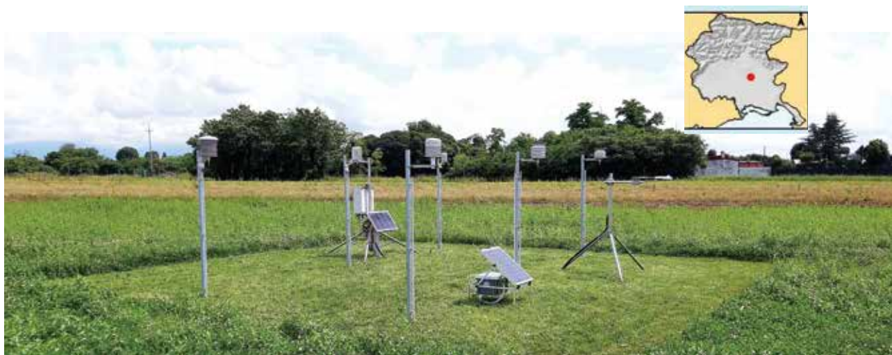
Slika 1. Testno polje blizu sinoptične postaje z različnimi ščitniki v Vidmu (Udine) S.O.
