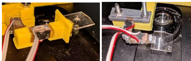
Slika 6: Vibracijski napravi brez mehanskih ojačevalnikov, zgrajeni iz plastike (levo) oz. aluminija (desno).
