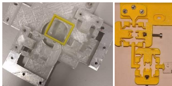
Slika 4: Vibracijska naprava s stekelcem pritrjenim neposredno na mehanizmu vibracijske naprave (levo) in popolnoma mehansko razklopljena različica (desno).
