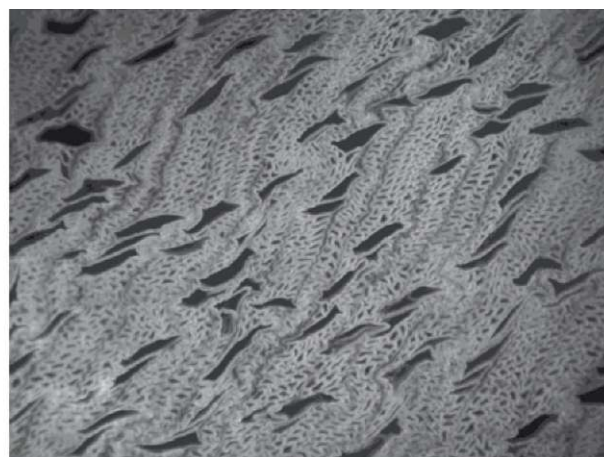
Slika 5: Svetlobna mikroskopija, prečni prerez: levo - vTC les in desno - les, proizveden z modificiranim vTC postopkom; obe sliki prikazujeta stanje po namakanju v vodi.
