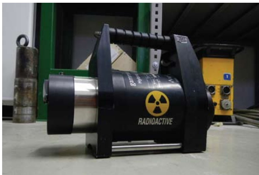
Slika 2: Zaščitni vsebnik z radioaktivnim virom za izvajanje industrijske radiografije (Vir: Arhiv ZVD)
