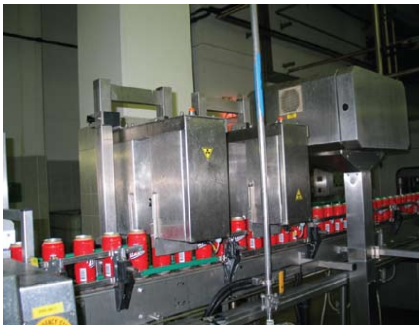
Slika 1: Merjenje nivoja tekočine v pločevinkah pijače (Vir: Arhiv ZVD)
