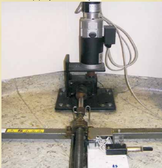
Slika 4: Motor, ki pomika voziček skozi obsevalni snop
