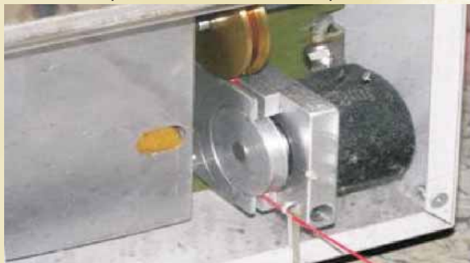
Slika 5: Dodatna kontrola z vrvico, ki nadzira gibanje vozička
