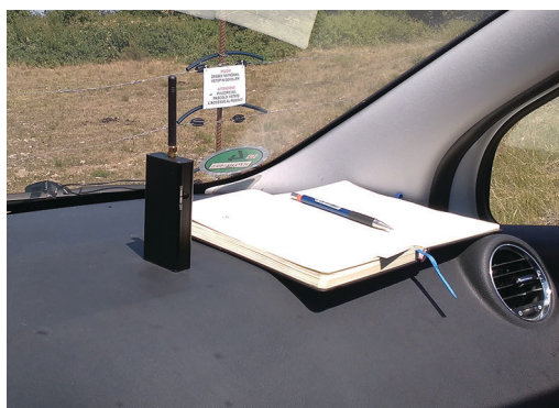
Slika 5: V vozilu nameščen motilnik povzroča kinematične motnje mirujočim obcestnim sprejemnikom.
