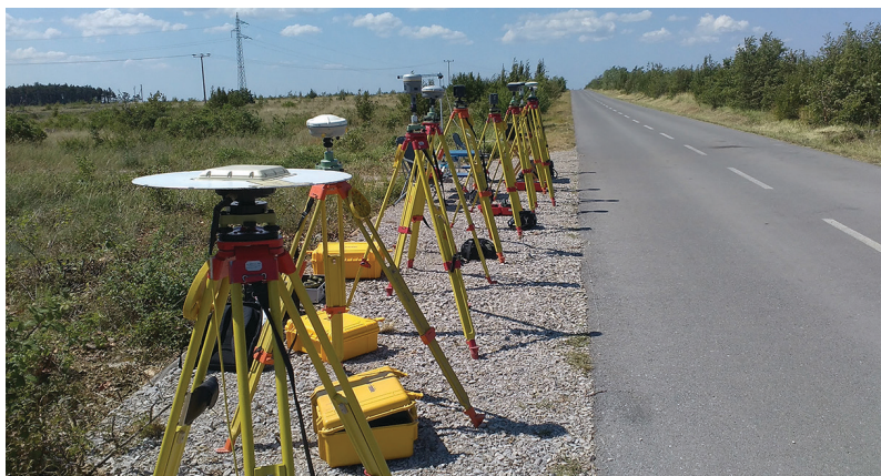
Slika 4: Geodetski instrumenti, testirani na motnje signala, ki preleta v frekvenčnem področju L1.
