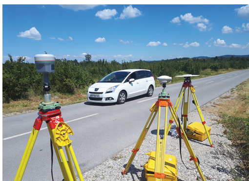
Slika 5: V vozilu nameščen motilnik povzroča kinematične motnje mirujočim obcestnim sprejemnikom.
