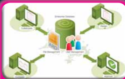
Centralno zasnovana podatkovna struktura platforme Esko ArtiosCAD Enterprise.
