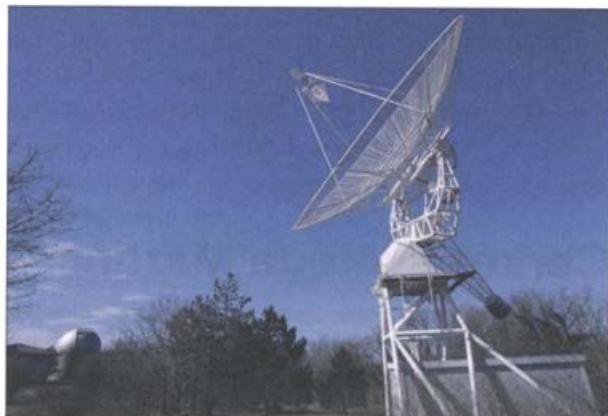
Antena radioteleskopa, ki sprejema radijske signale s Sonca. Na levi strani slike je kupola, kjer je reflektor-teleskop z zrcalom premera 0,5m. (Foto: T. Valente)
